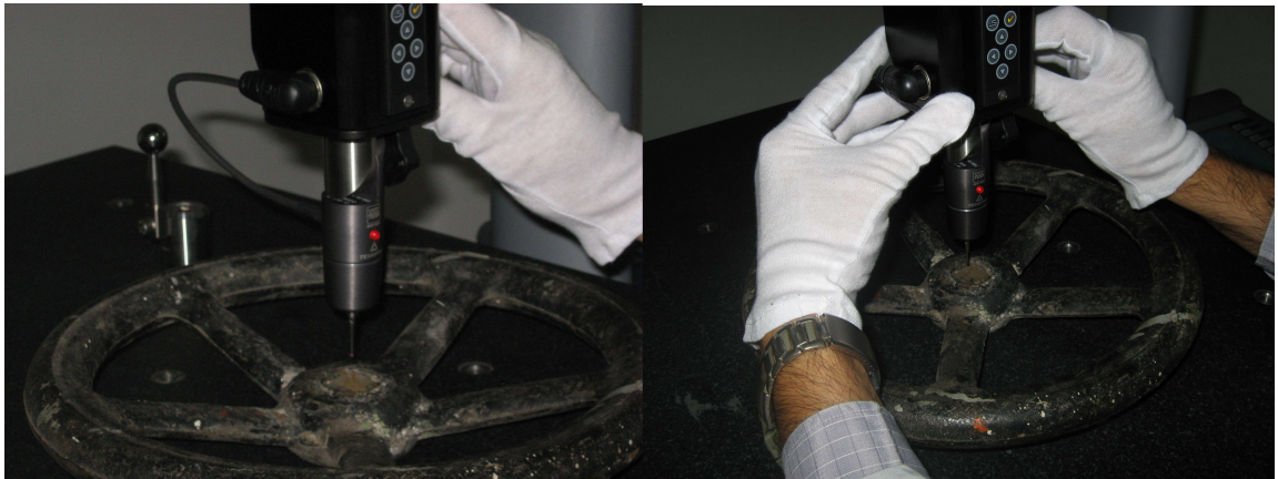
Fig. 6.12. Măsurarea profilului real
