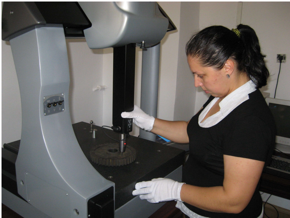
Fig. 6.6. Măsurarea profilului roţii pe maşina Micro Hite 3D (la Universitatea Dunărea de Jos echipament procurat prin contractul de cercetare ID_656/2007)
